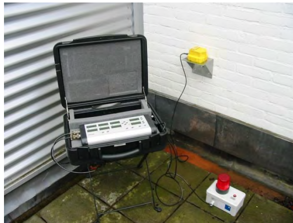
Figuur 8.12.4 Voorbeeld trillingsmeet apparatuur
