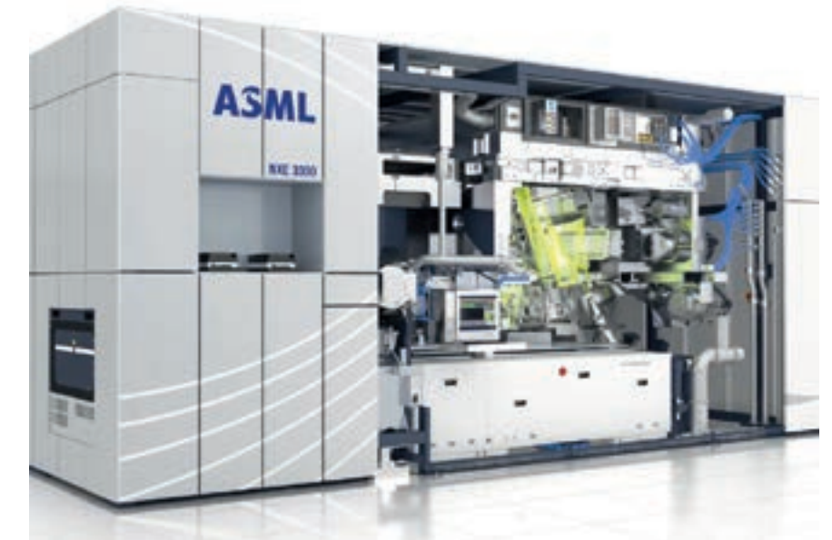
De waferstepper NXE 3300 maakt gebruik van extreem ultraviolet (EUV) licht.
