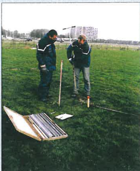
↑ Figuur b Uitvoering gutsboring (Broekpolder), op de voorgrond de kist met gootjes om de monsters mee te nemen naar het lab
