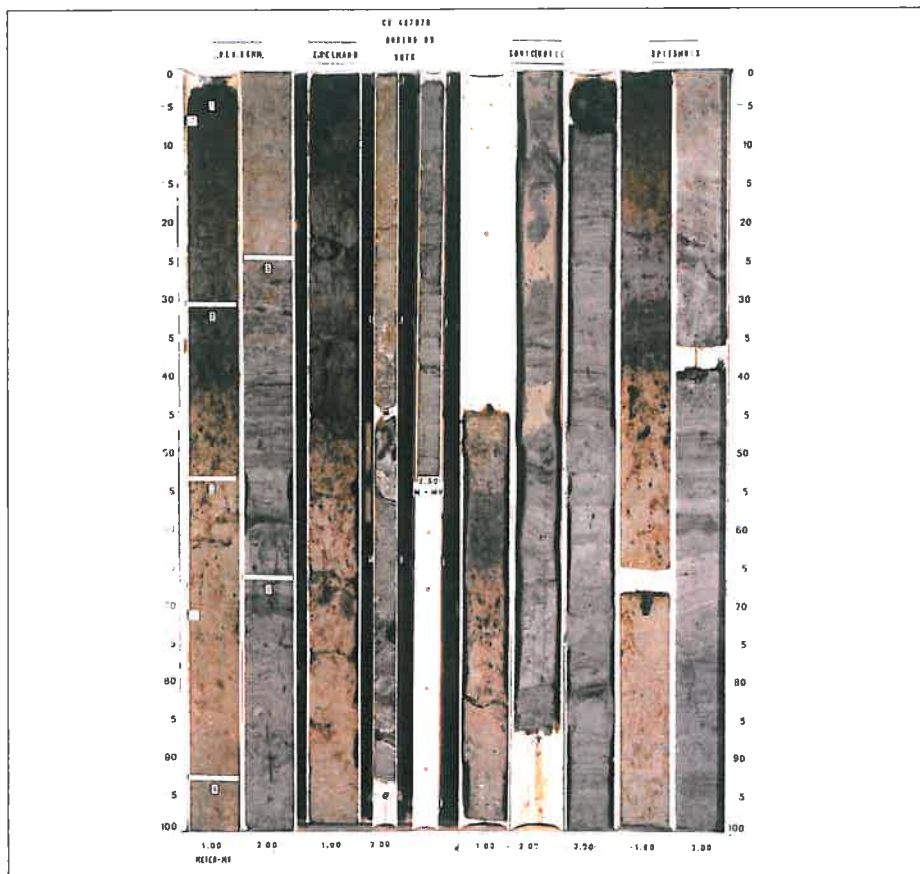
↑ Figuur 3 Boorkernen van de verschillende boorsystemen bij boorlocatie og in de Broekpolder, v.l.n.r. de Begemann, de Edelman, de guts, de Spitsmuis en de Sonic Drill.
