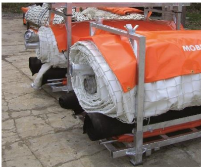
Mobiele Dijkmodules Lengte: 78 meter Hoogte: 350 cm, Breedte 700 cm
